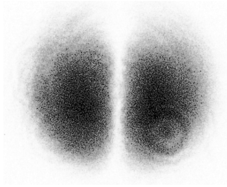
Abbildung 5: Photographie der TEM_{10} -Mode. Das Bild wurde invertiert und der Kontrast erhöht. Im rechten unteren Teil der Mode ist eine Interferenzerscheinung erkennbar, deren Herkunft wir nicht klären können.
